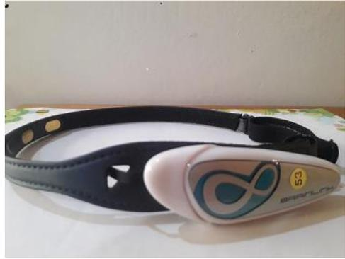
BrainLink Lite頭箍採用了黑色皮革柔軟材質設計，寬度適中，在佩戴中不會有太多不適，攜帶上也十分方便。在頭箍左側為主機固定底座，採用了夾持設計，雖然可拆卸，但是其連接線相對較為脆弱，日常使用要多注意保護。
