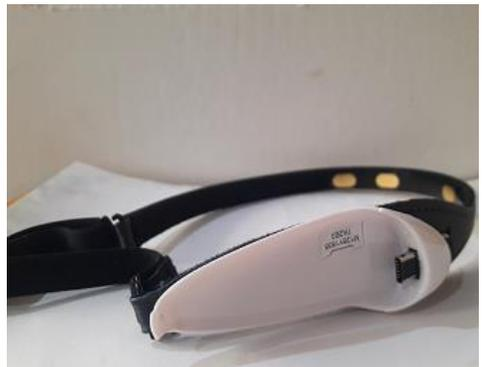
在頭箍前額位置內側，可以看到三片非對稱設計的超薄電極片，BrainLink Lite正是通過三片電極片採集腦電波與主機相連，實現相關監測及意念力互動操控。
